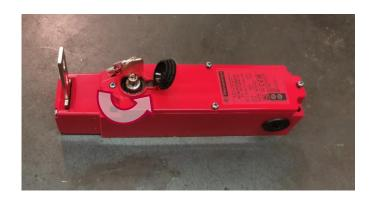
TURNING THE RELEASE DEVICE
