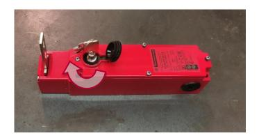
TURNING THE RELEASE DEVICE
