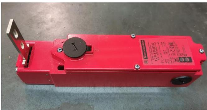
WORKING POSITION - LOCKED LIMIT SWITCH
