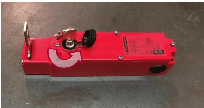
TURNING THE RELEASE DEVICE
