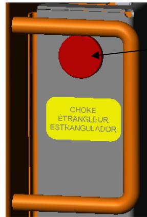
Le bouton de l'étrangleur est situé sur le côté du panneau de branchement hydraulique pour accessoires, sous le boîtier de contrôle.
